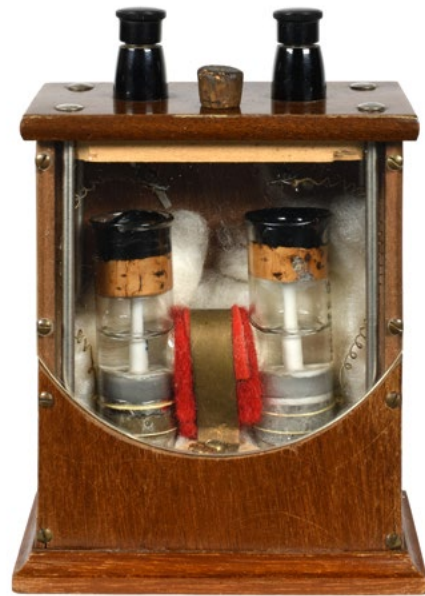
Weston-Normalelement geöffnet (Bild: Wissenschaftliche Sammlung Alexander Kudas)
