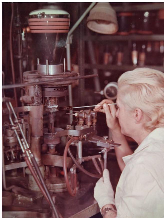
Einschmelzen einer B16S22 auf der Vertikaleinschmelzmaschine, um 1955
