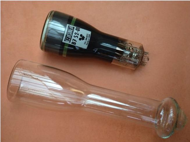
Rohkolben und fertige Oszillographenröhre B7S2-01
