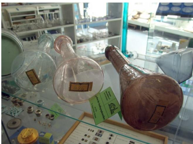
Rohkolben für Oszillographenröhren um 1930, Fischerhütte Ilmenau, Sammlung Verein Thüringer Glastradition Ilmenau e.V.
