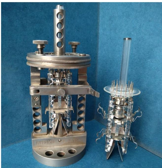
Montagevorrichtung für B7S2 mit einschiebefertigem System, Muster 1979
