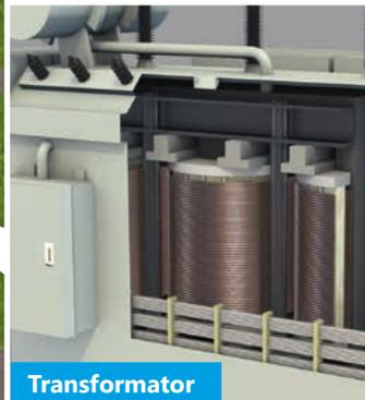
Im Trafo sind zwei Spulen mit unterschiedlicher Wicklungszahl um einen großen Metallkern gewickelt. (Eine Spule ist nichts weiter als ein aufgewickelter Metalldraht – konkret sind es Kupfer- oder Aluminiumspulen.)
