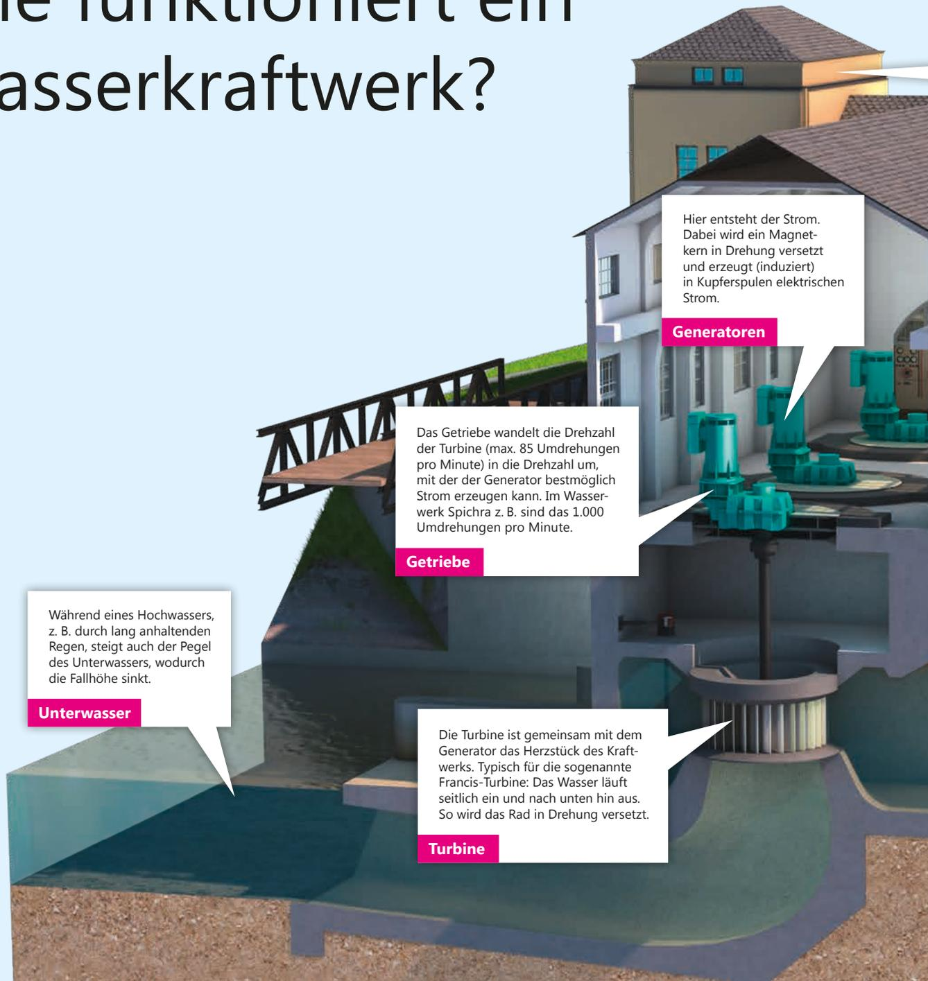
Hier entsteht der Strom. Dabei wird ein Magnetkern in Drehung versetzt und erzeugt (induziert) in Kupferspulen elektrischen Strom.
