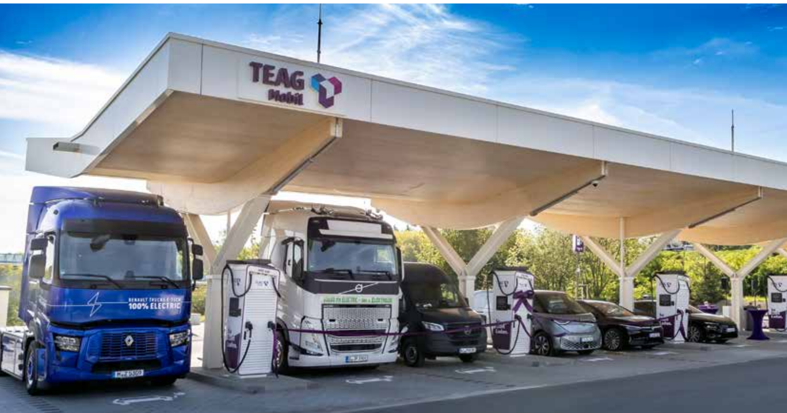
Der Ladepark der TEAG Mobil bei Schleiz ist vor allem für den Fernverkehr auf der Autobahn A9 wichtig. Der architektonisch interessante Bau bietet 40 HPC-Ladepunkte bis 400 kW für E-Trucks.
