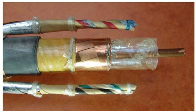
Detailaufnahme des FK 501, Fernseh-Koaxialkabel und geschirmte Rundfunkkabel
