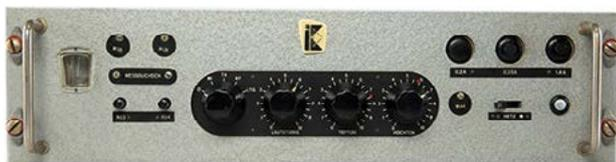
(\* 25-W-Kraftverstärker aus dem VEB Funkwerk Kölleda (Foto: G. Roleder)
