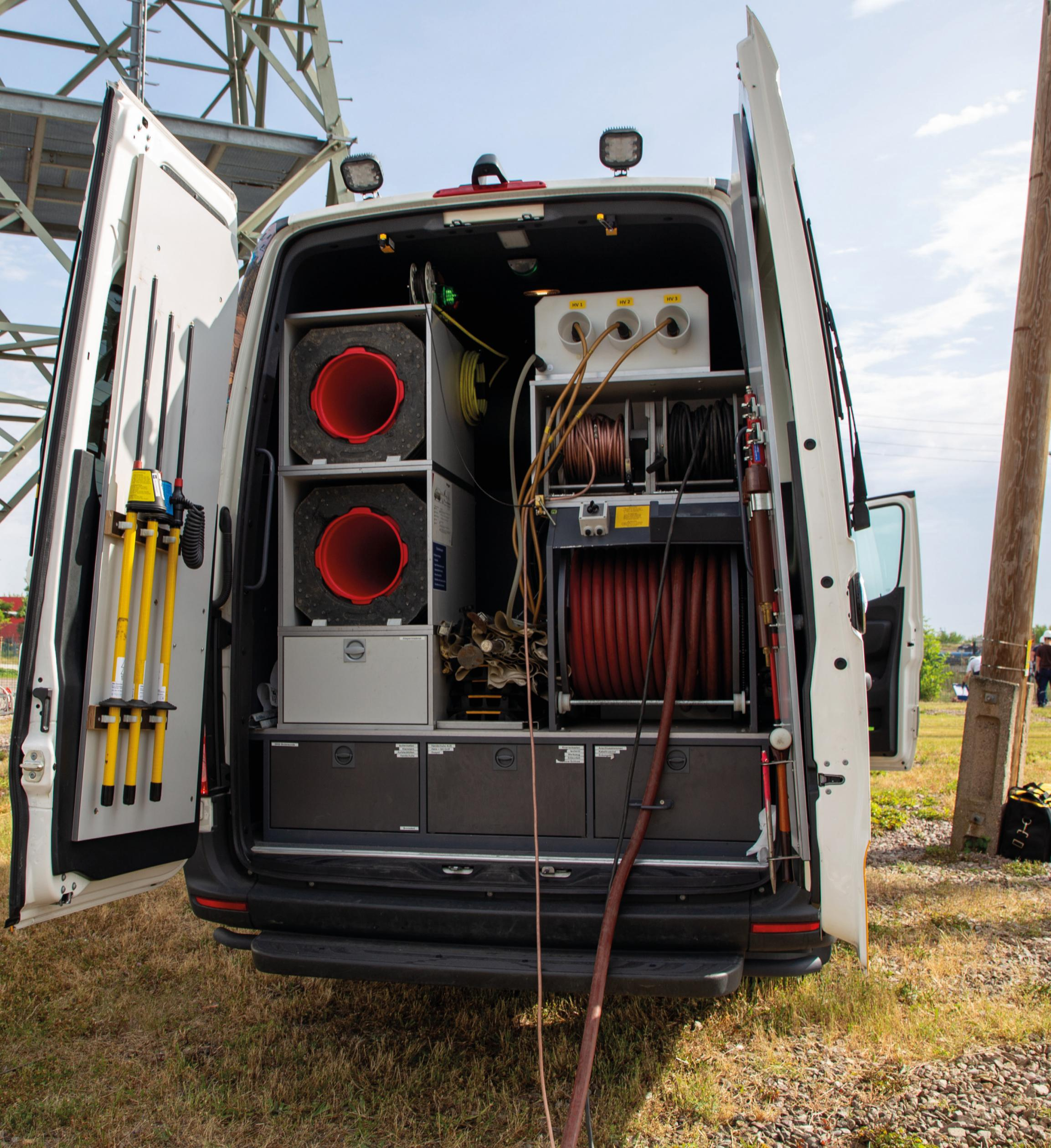
**Ausgestattet mit einer Vielzahl von Prüf- und Messgeräten, ermöglicht er präzise Zustandsermittlung von und Fehlersuche an Energiekabeln direkt vor Ort. Den richtigen Umgang und die Bedienung erlernt man unter anderem an der TEAG Akademie in Erfurt.**
